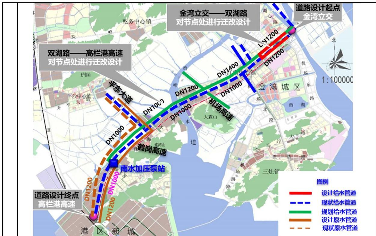
图 2-52 给水工程设计系统简图
