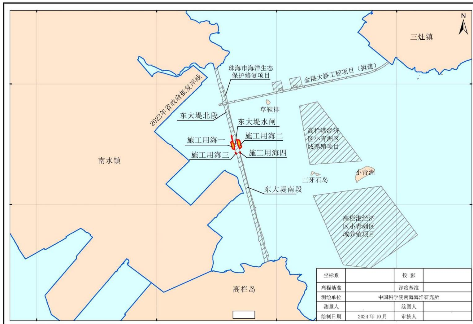
图 2.4-6 本项目施工用海平面布置图
