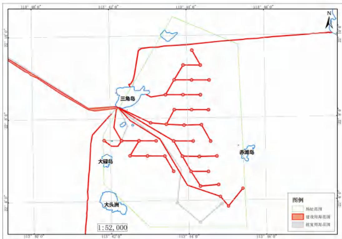
图 7.2.5-1 调整方案集电线路布置示意图
