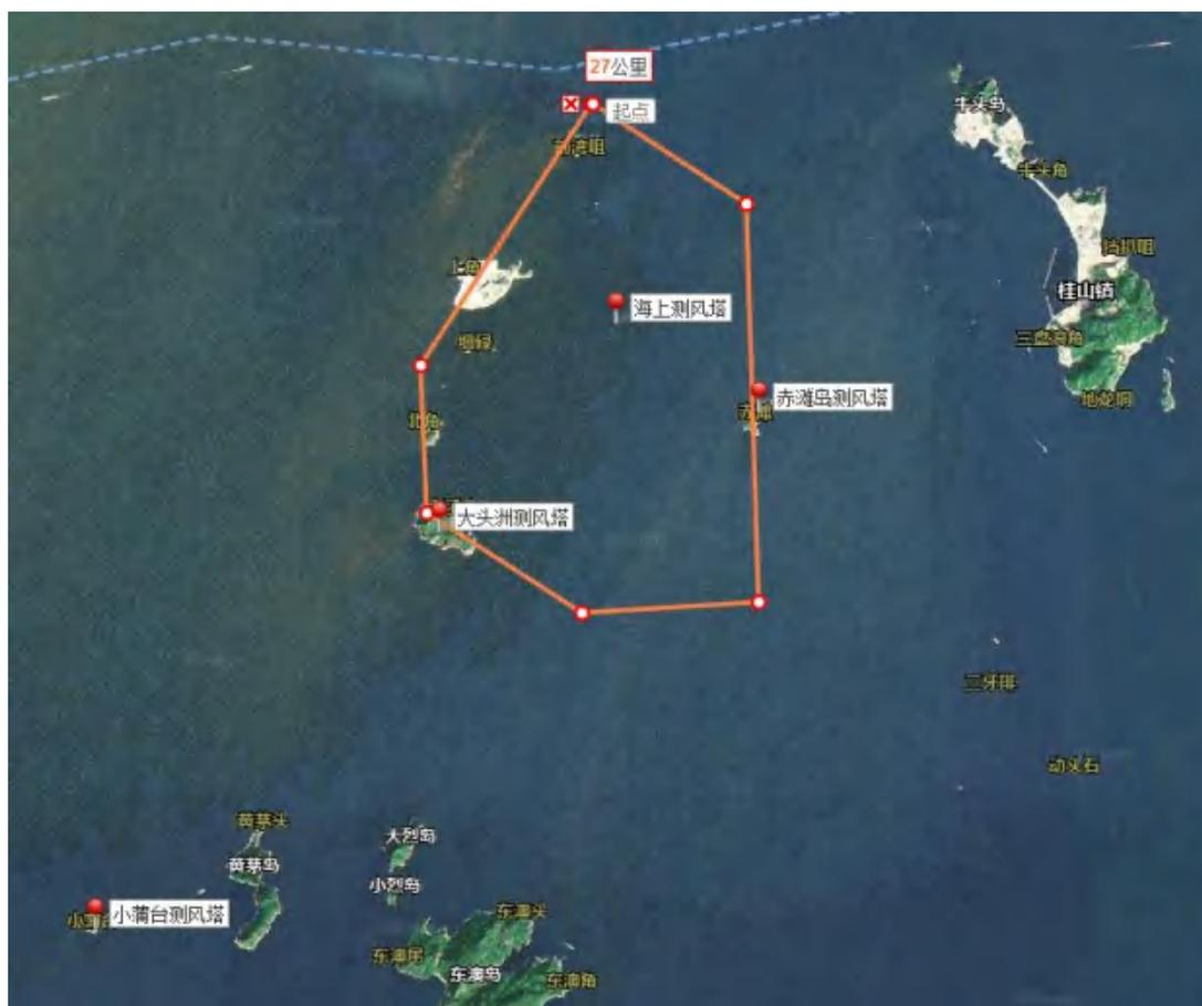
图 3.1.8-1 桂山海上风电场测风塔分布示意图
