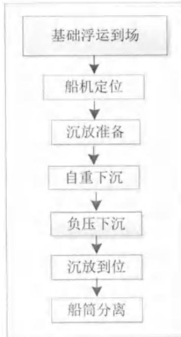
图 2.3.1-5 基础沉放施工顺序图
