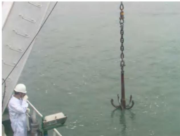
图 2.3.2-3 扫海清障锚链示意图
