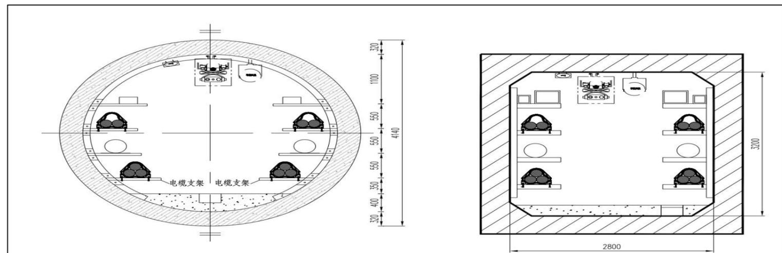
新建电力隧道断面1
